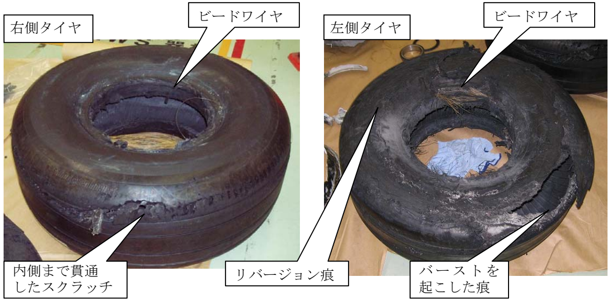
写真3 脱落した左右前輪
